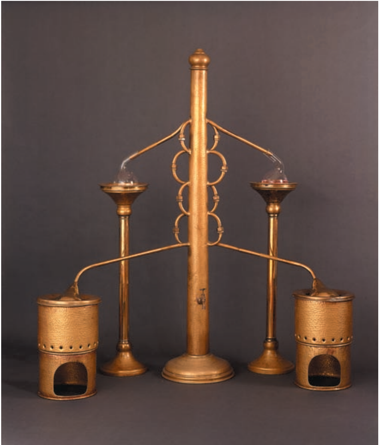
Apparat zur Destillation von Weingeist
