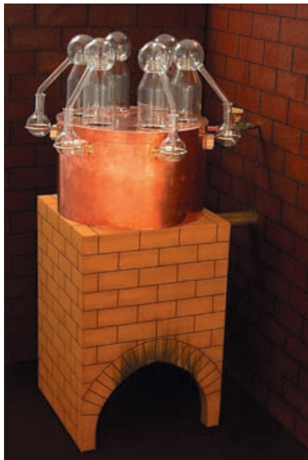
Unser Modell: Kupfer und Holz, kaschiert. 6 Alembiks aus Glas. Gesamthöhe 1,2 m. (Inventar-Nr. K 1.63)
