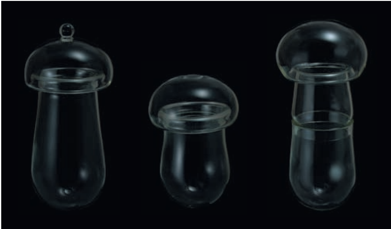
Unser Modell ( Alembic No. 6 ): Glas, farblos. Zweiteilig. Höhe: 19 cm. (Inventar-Nr. K 1.33)
